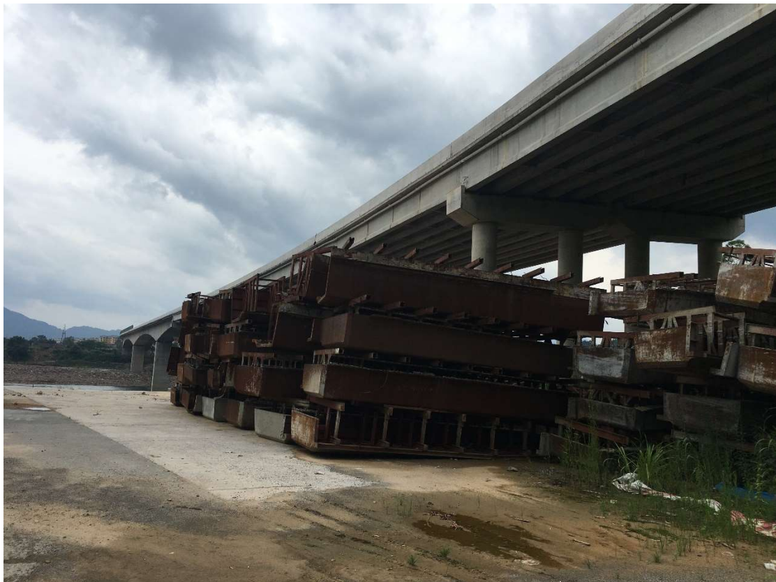
1#废旧模板 T 梁模板、存放地点：昭平县（图 2）
